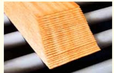
Das Furnierpaket wird unmittelbar nach dem Leimauftrag längs und quer aufgefächert.
