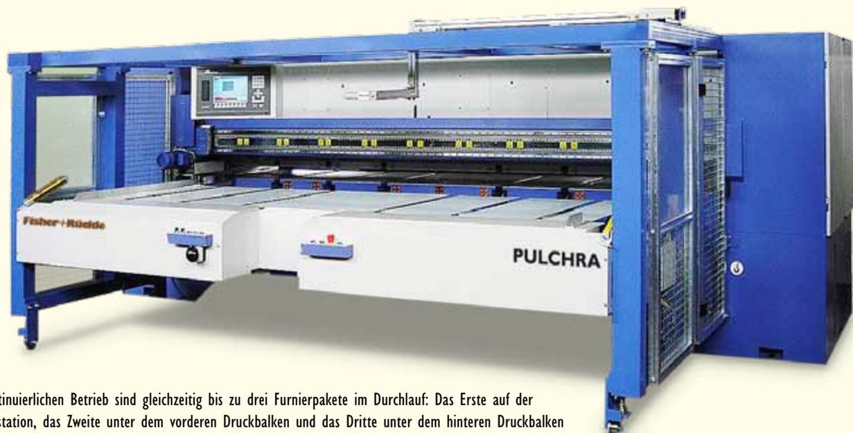
Im kontinuierlichen Betrieb sind gleichzeitig bis zu drei Furnierpakete im Durchlauf: Das Erste auf der Vorlegestation, das Zweite unter dem vorderen Druckbalken und das Dritte unter dem hinteren Druckbalken kurz vor der Austragevorrichtung.
