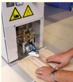
Optisch gesteuerter, automatischer Einzug für effiziente Beschickung
